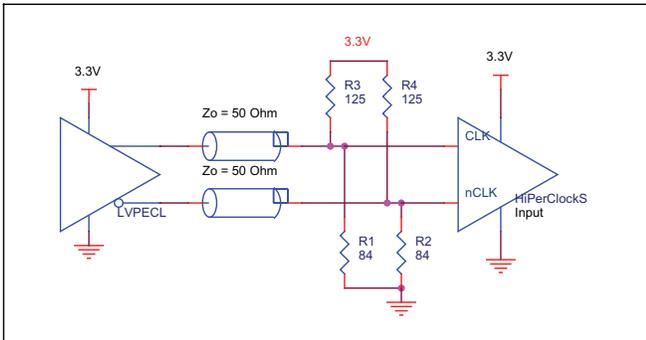
**FIGURE 4C. CLK/nCLK INPUT DRIVEN BY 3.3V LVPECL DRIVER**
