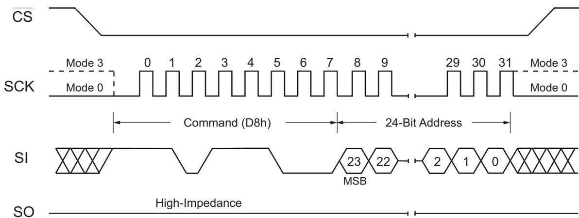
Figure 65. 64-kByte Block Erase Command (SPI Mode)
