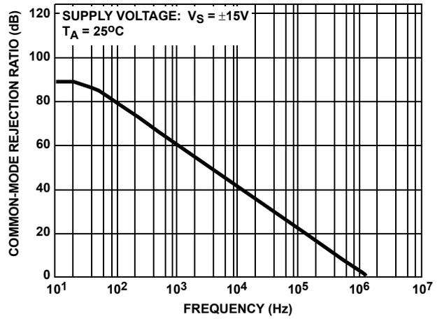
FIGURE 34. COMMON MODE REJECTION RATIO vs FREQUENCY
