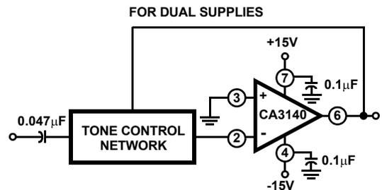
FIGURE 20. BAXANDALL TONE CONTROL CIRCUIT USING CA3140 SERIES
