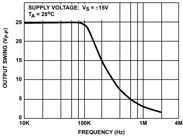
FIGURE 33. MAXIMUM OUTPUT VOLTAGE SWING vs FREQUENCY
