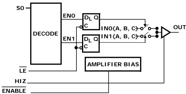
A LOGIC HIGH ON  $\overline{LE}$  WILL LATCH THE LAST S0 STATE.
