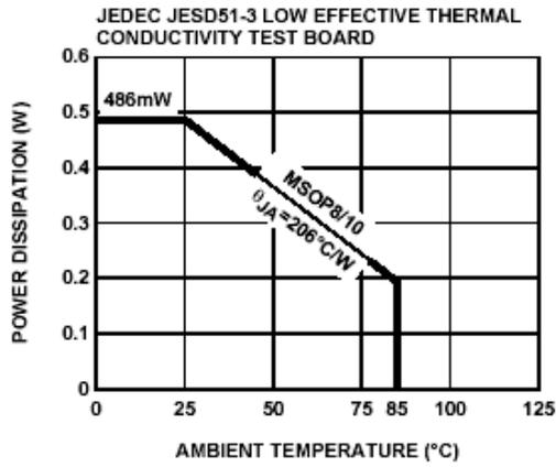
FIGURE 13. PACKAGE POWER DISSIPATION vs AMBIENT TEMPERATURE
