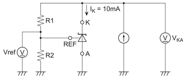
$$V_{KA} \cong V_{ref} \times \frac{R1 + R2}{R2}$$
