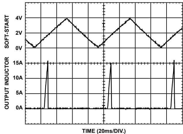
FIGURE 4. OVERCURRENT OPERATION
