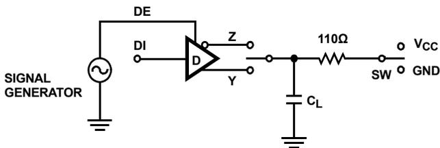
FIGURE 8A. TEST CIRCUIT
