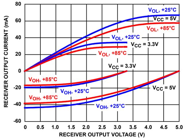
FIGURE 15. RECEIVER OUTPUT CURRENT vs RECEIVER OUTPUT VOLTAGE
