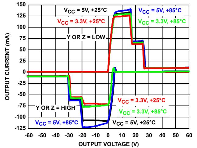
FIGURE 17. DRIVER OUTPUT CURRENT vs SHORT-CIRCUIT VOLTAGE
