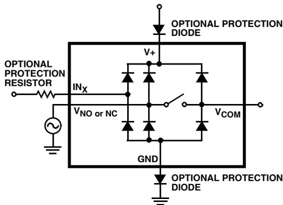
FIGURE 8. OVERVOLTAGE PROTECTION
