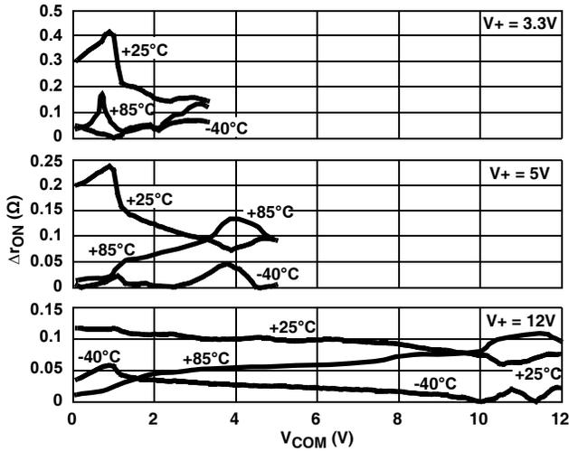
FIGURE 11. r<sub>ON</sub> MATCH vs SWITCH VOLTAGE
