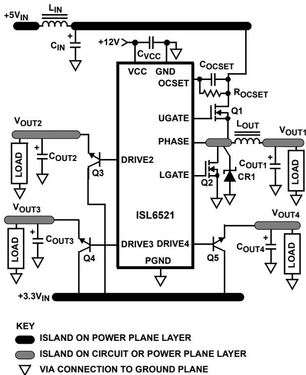
FIGURE 7. PRINTED CIRCUIT BOARD POWER PLANES AND ISLANDS
