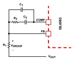
FIGURE 8. COMPENSATION CONFIGURATION FOR ISL6563 CIRCUIT
