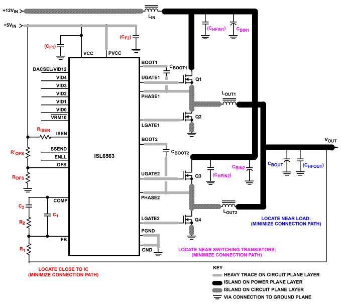
FIGURE 9. PRINTED CIRCUIT BOARD POWER PLANES AND ISLANDS
