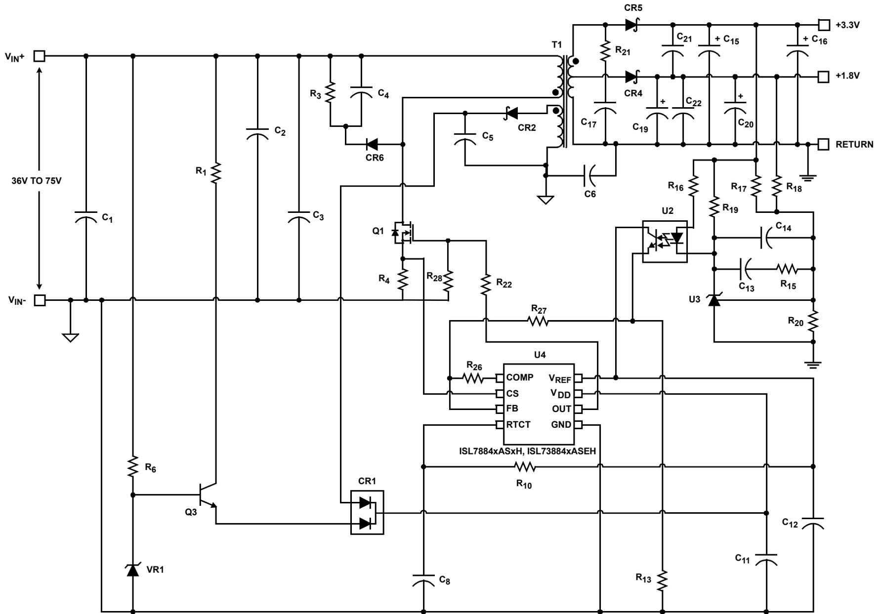
FIGURE 2. TYPICAL APPLICATION - 48V INPUT DUAL OUTPUT FLYBACK
