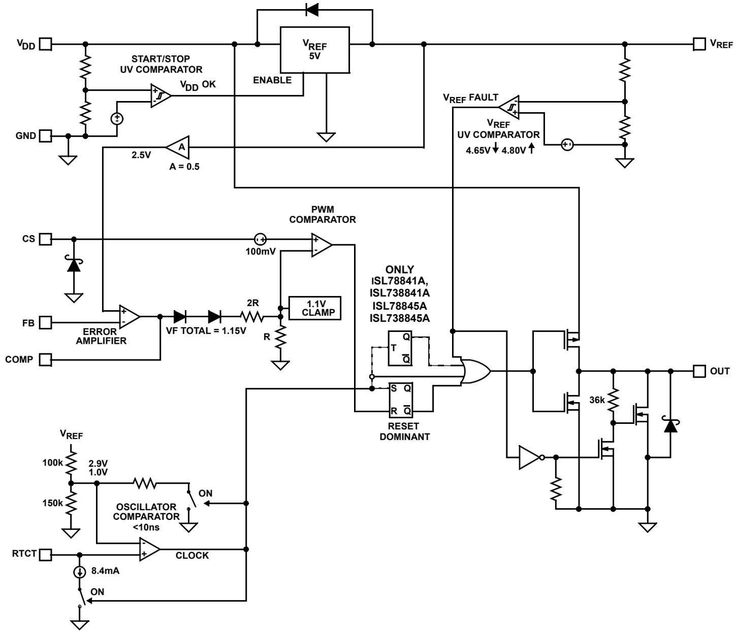
FIGURE 1. BLOCK DIAGRAM
