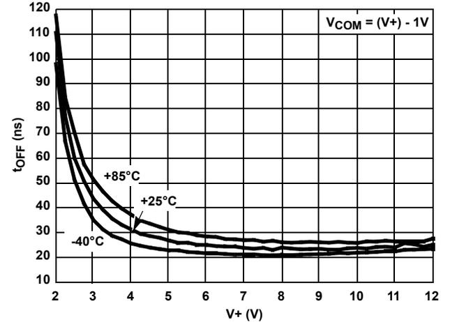
FIGURE 12. TURN - OFF TIME vs SUPPLY VOLTAGE
