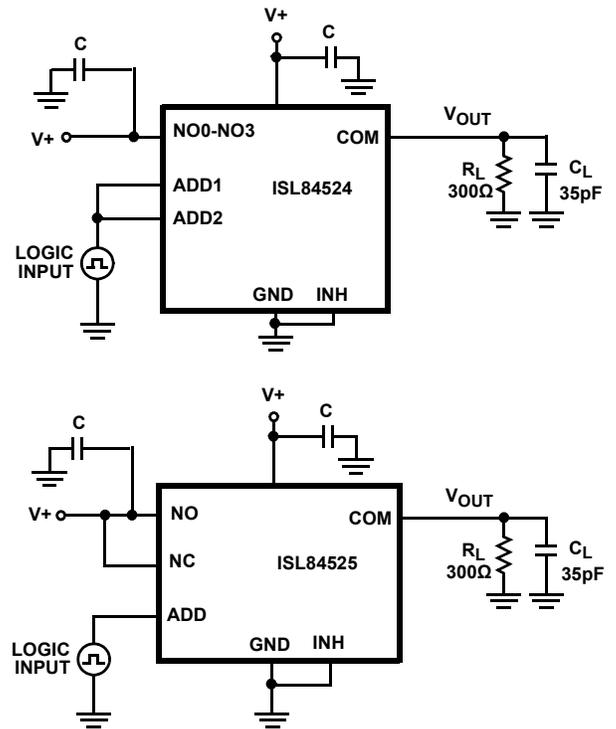
FIGURE 3B. TEST CIRCUIT
