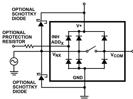
FIGURE 8. OVERVOLTAGE PROTECTION
