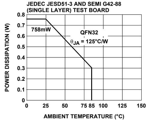
FIGURE 14. PACKAGE POWER DISSIPATION vs AMBIENT TEMPERATURE
