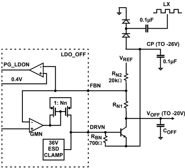
FIGURE 19. V<sub>OFF</sub> FUNCTIONAL BLOCK DIAGRAM
