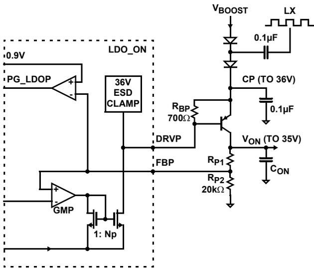
FIGURE 18. V<sub>ON</sub> FUNCTIONAL BLOCK DIAGRAM
