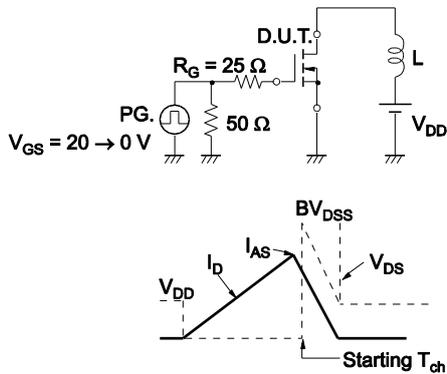
**TEST CIRCUIT 2 SWITCHING TIME**
