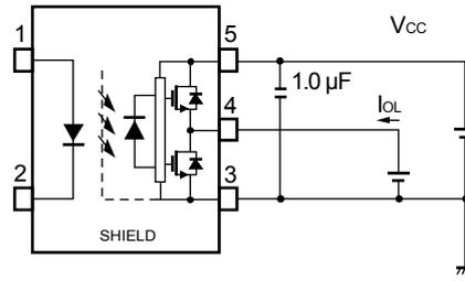
Fig. 3  $V_{OH}$  Test Circuit
