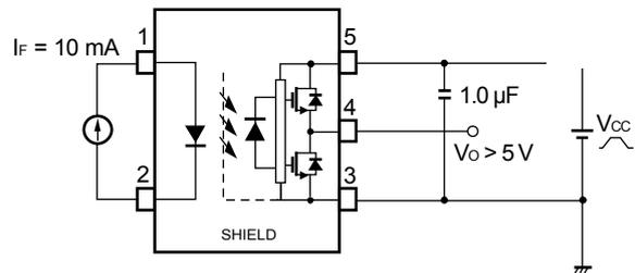
**Fig. 7 IFLH Test Circuit**
