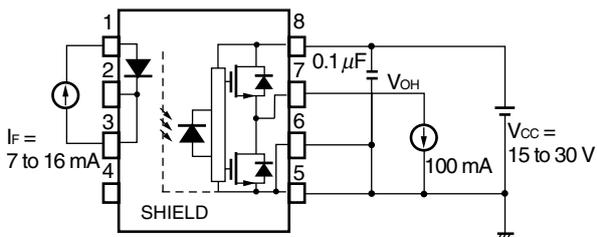
Fig. 4  $V_{OL}$  Test Circuit
