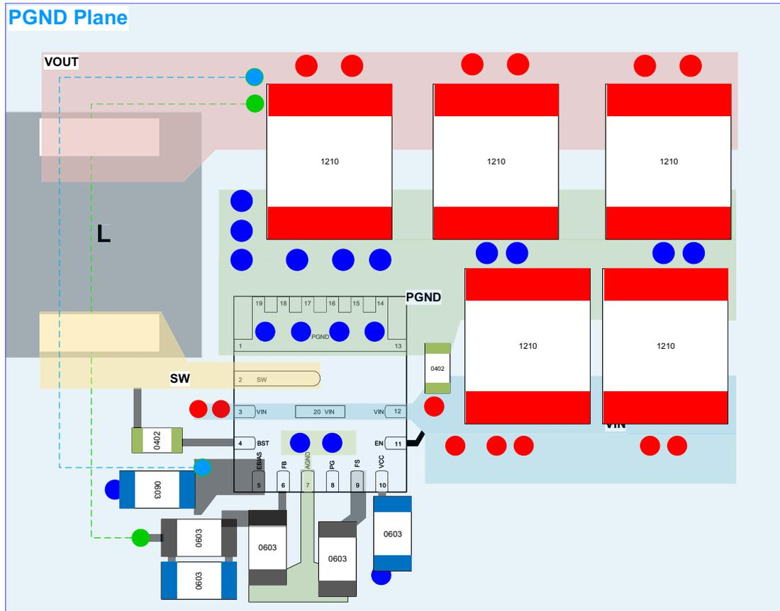
Figure 28. QFN Package Layout Recommendation
