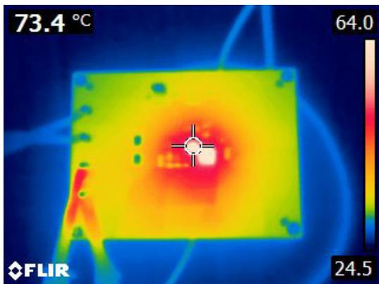
Figure 21. Thermal Image, 24V<sub>IN</sub>, 3.3V<sub>OUT</sub>, 400kHz, 5A, QFN, T<sub>J</sub> = 73.4°C
