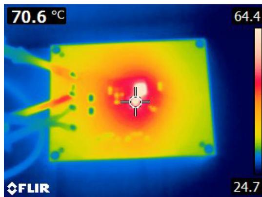
Figure 23. Thermal Image, 24V<sub>IN</sub>, 3.3V<sub>OUT</sub>, 400kHz, 5A, HTSSOP, T<sub>J</sub> = 70.6°C
