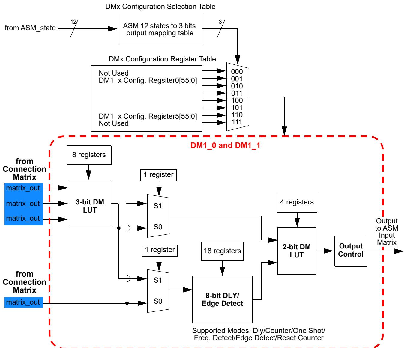
Figure 114: DM1\_0/DM1\_1 Inputs
