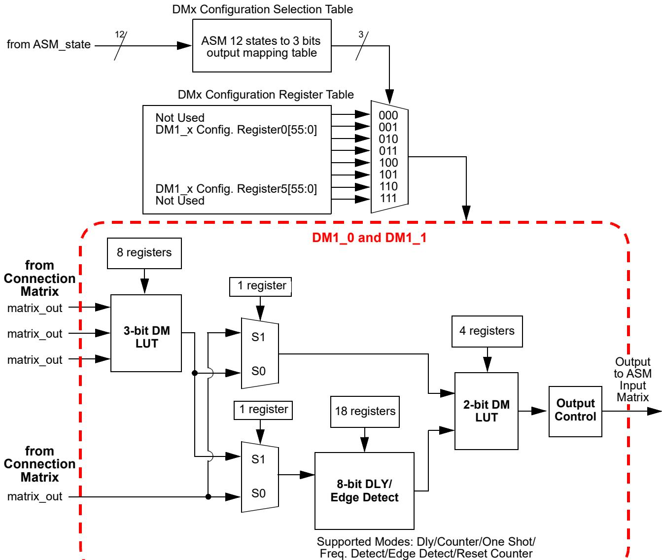
Figure 112: DM1\_0/DM1\_1
