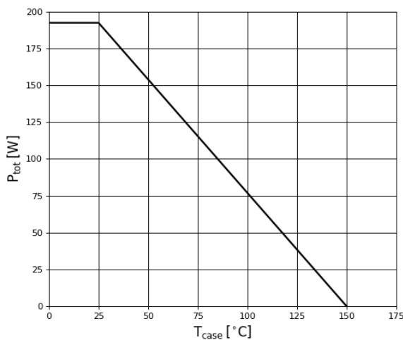
**Figure 11. Power Dissipation**
