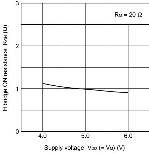
**R<sub>ON</sub> vs. V<sub>M</sub> Characteristics**
