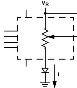
TWO-TERMINAL VARIABLE RESISTOR;
