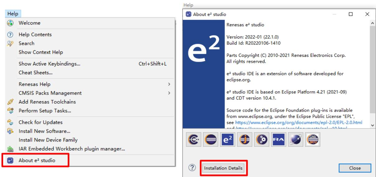
2.2 如果使用RA Smart Configurator，选择Help/About DDSC Smart Configurator，点击Installation Details
