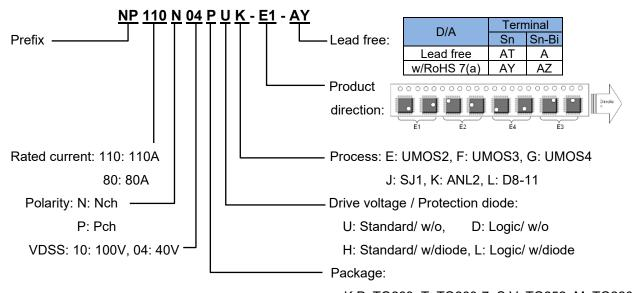
K,P: TO263, T: TO263-7, S,V: TO252, M: TO220 N: TO262, H: TO251, Y: HSON-8, Q: HSON-8 Dual
