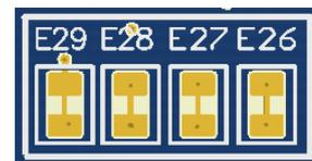
J-Link 断开线切跳线 E26、E27、E27 和 E28，将 J-Link 信号连接到 MCU 编程接口。E26、E27、E28 和 E29 默认是短接的，将 MCU 的调试信号连接到 JTAG 接口。
