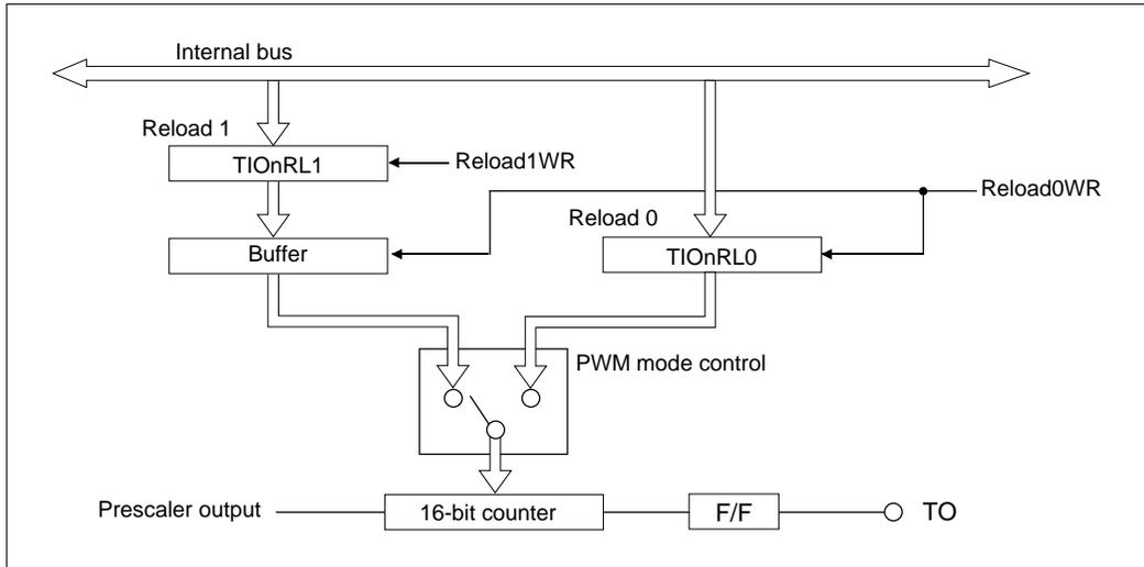
**Figure 10.4.13 PWM Circuit Diagram**
