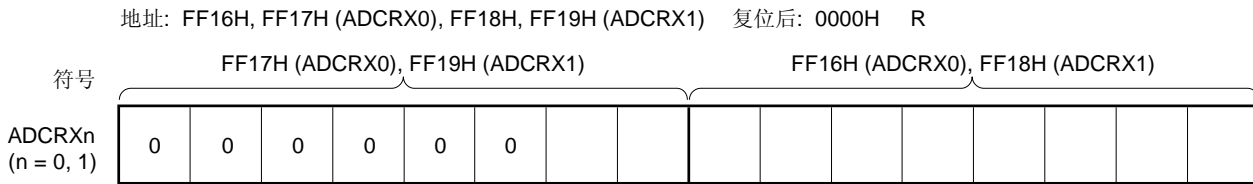
图 11-8. 用于 TMXn 同步的 10 位 A/D 转换结果寄存器 (ADCRXn) 的格式
