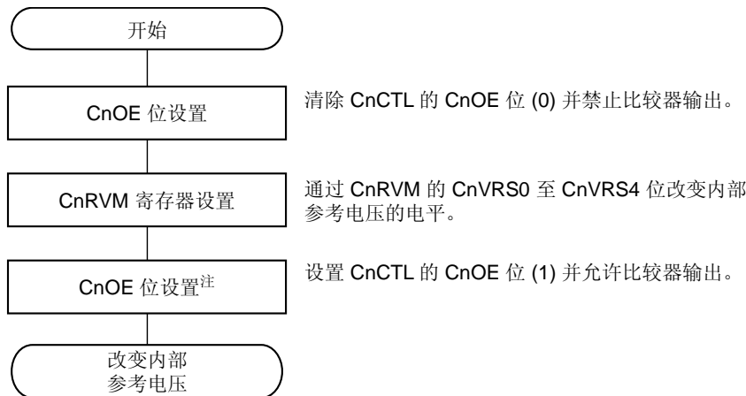
图 13-12. 改变内部参考电压时的设置步骤举例
