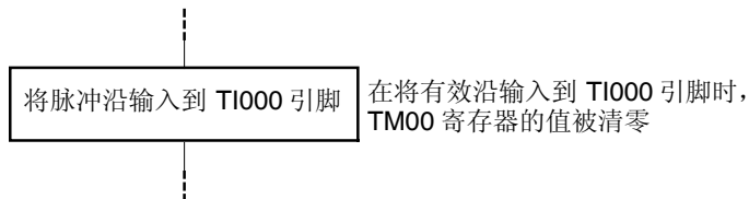
<2> TM00 寄存器清零&启动流程
