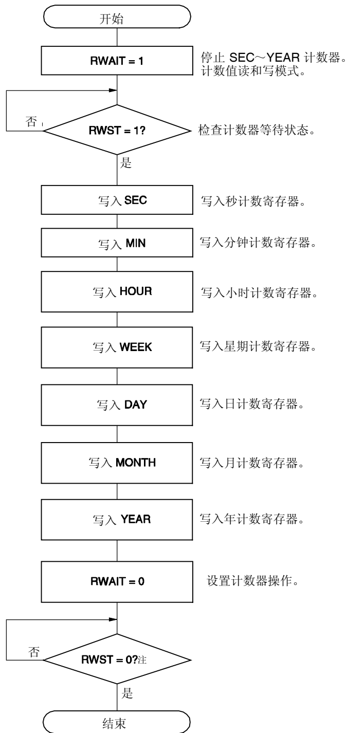
图 9-20. 写入实时计数器的操作流程
