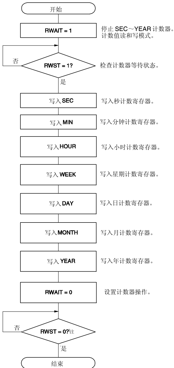
图 9-20. 写入实时计数器的操作流程
