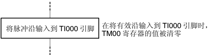
<2> TM00 寄存器清零&启动流程
