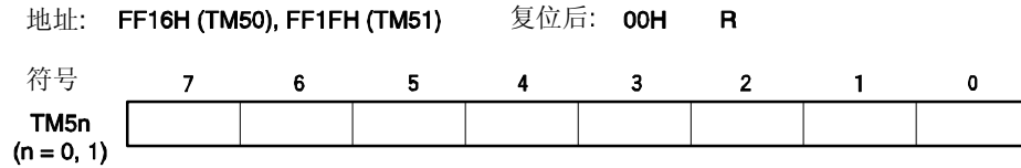
图 7-4. 8 位定时器计数器 5n (TM5n)的格式
