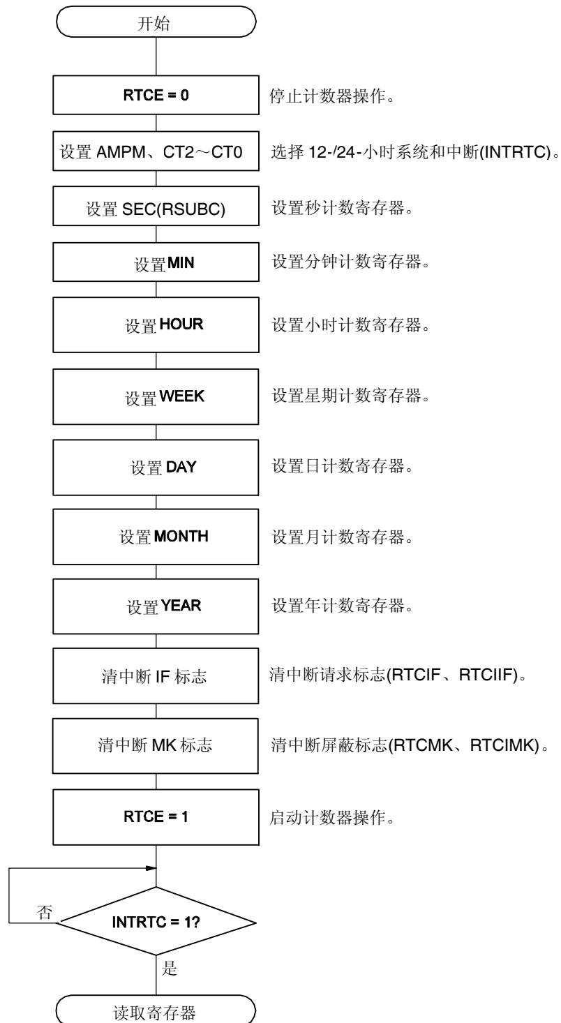
图 9-18. 启动实时计数器的操作流程
