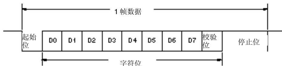
图 14-7. 正常 UART 发送/接收数据的格式
