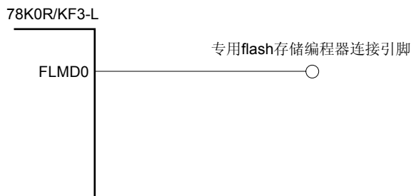
图 23-4. FLMD0 引脚连接示例
