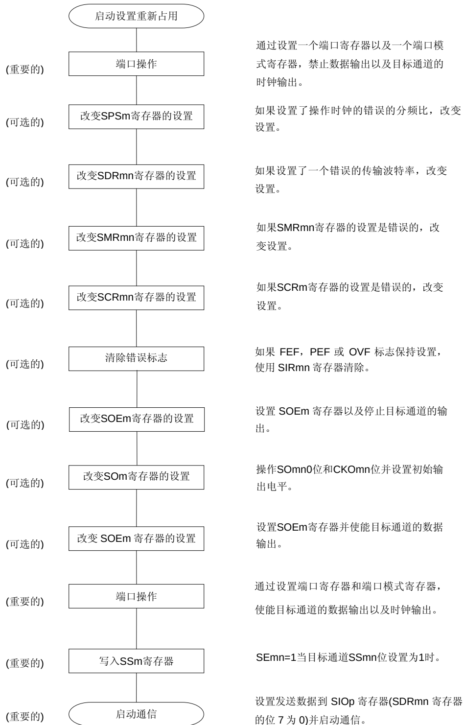
图 11-27. 重新主发送的程序
