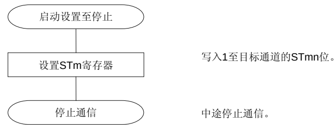
图 11-78. UART 接收的停止程序
