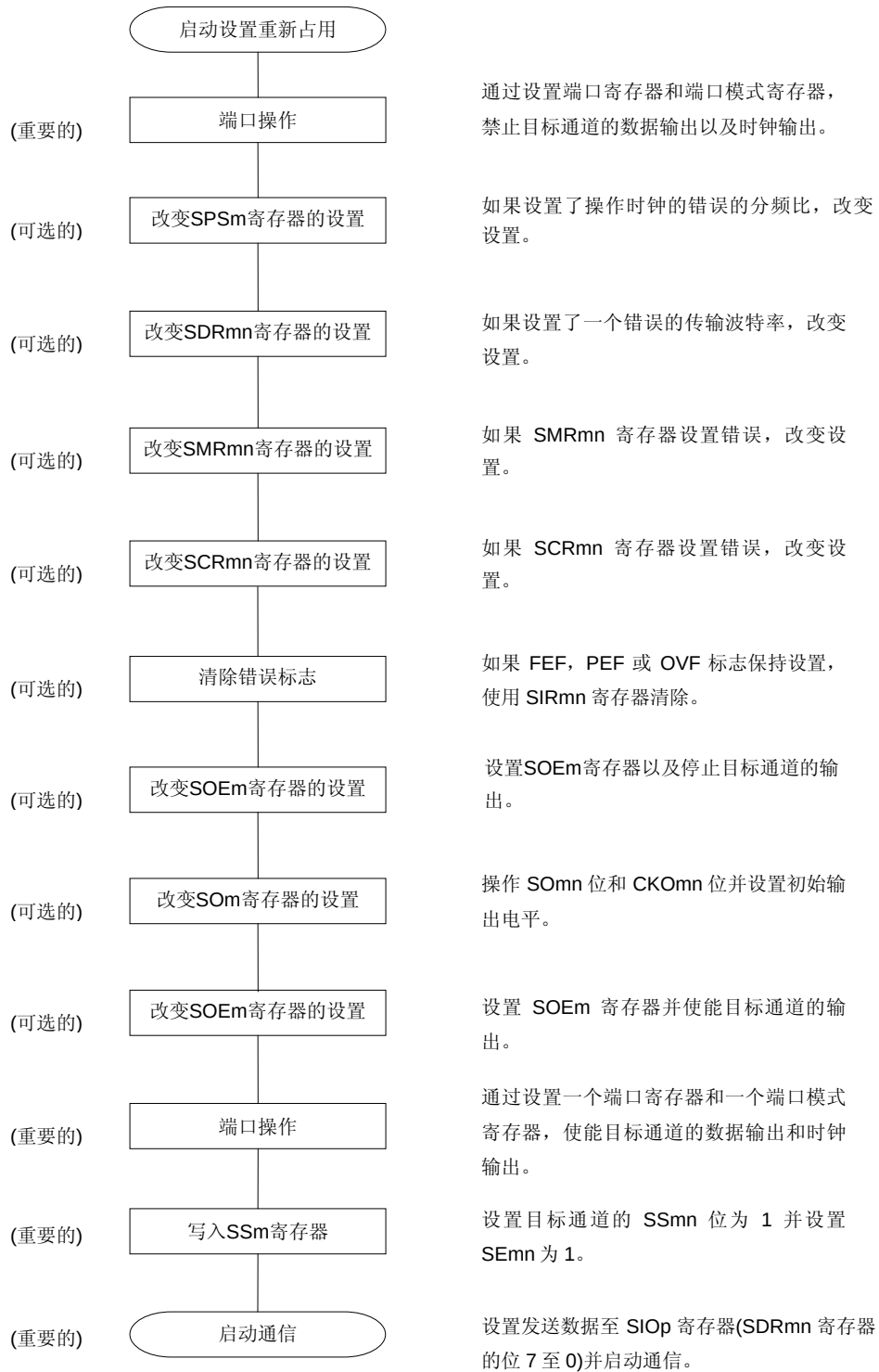
图 11-41. 重新主发送/接收的程序
