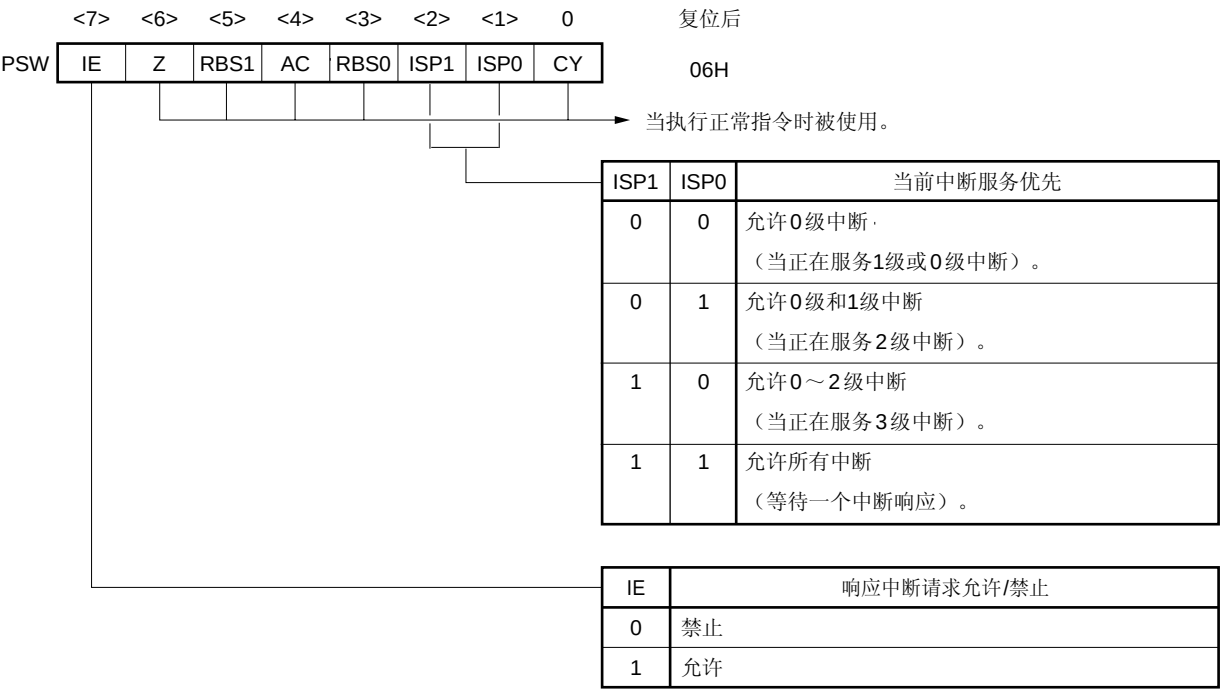
图 15-6. 程序状态字的格式
