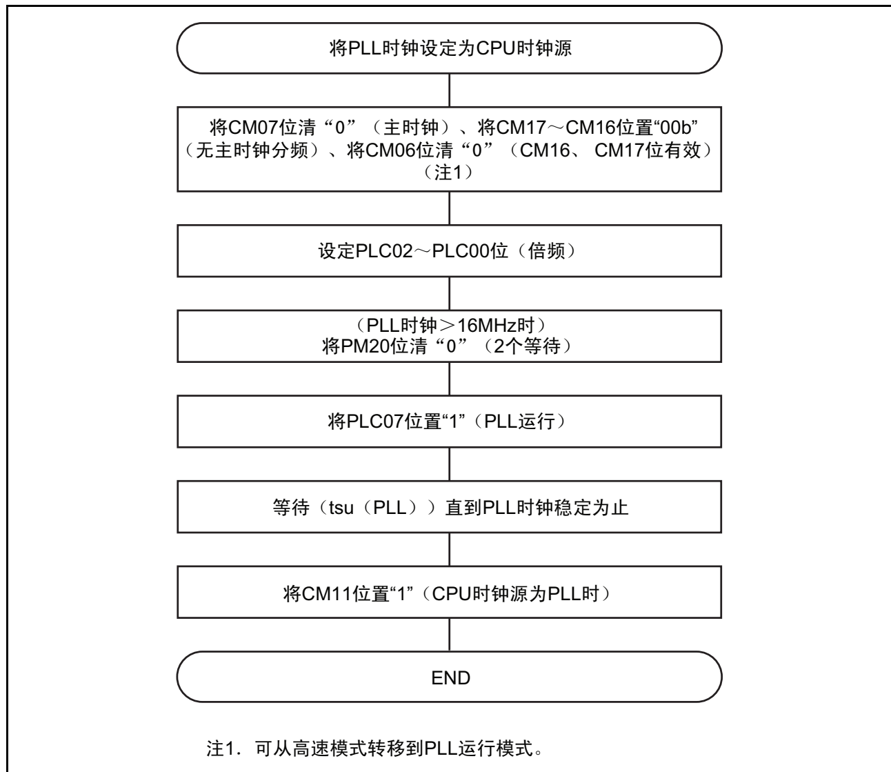
图 9.11 将 PLL 时钟置为 CPU 时钟源的步骤
