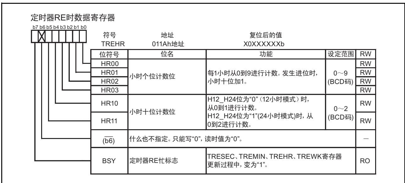
图 17.29 实时时钟模式时的 TREHR 寄存器
