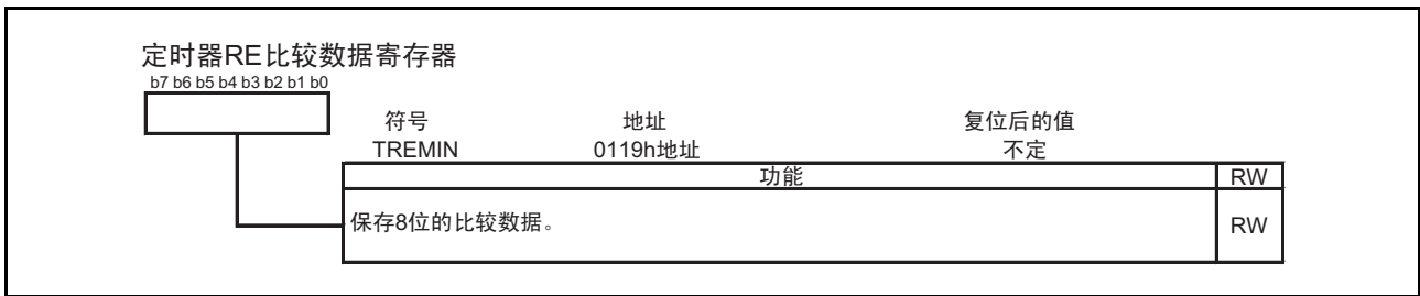
图 17.39 输出比较模式时的 TREMIN 寄存器
