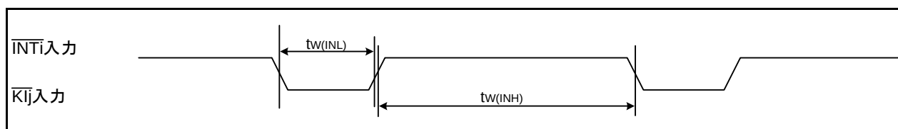
図 30.12 外部割り込み \overline{\text{INTi}} およびキー入力割り込み \overline{\text{KIj}} の入力タイミング ( i = 0 \sim 4 、 j = 0 \sim 3 )
