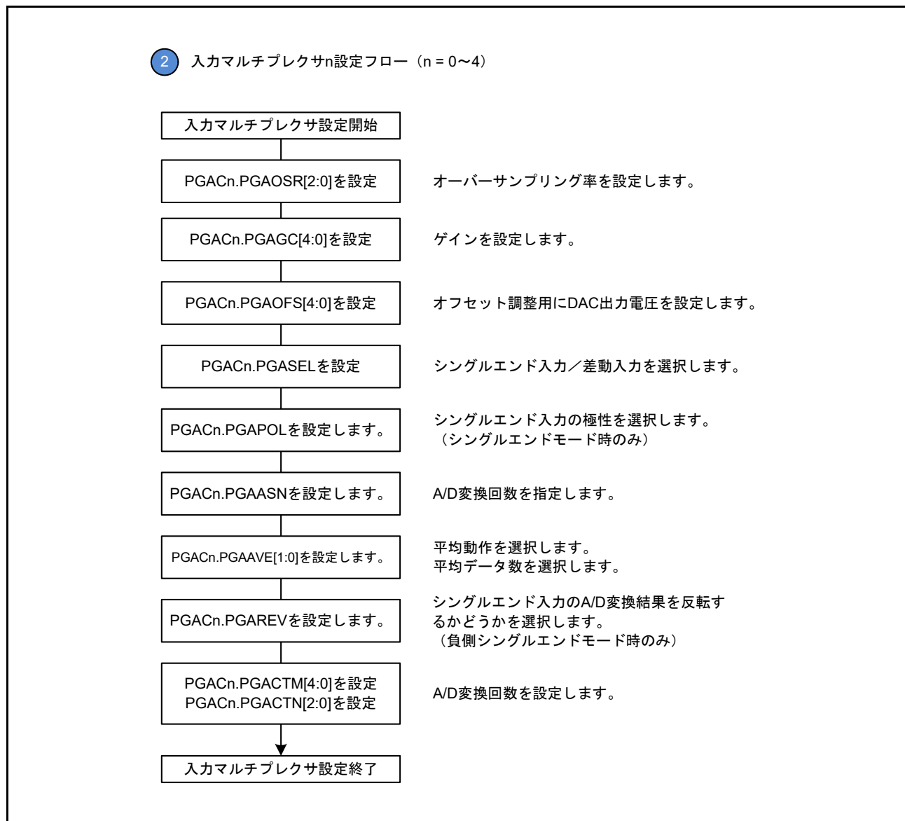
図 33.25 入力マルチプレクサ設定フロー
