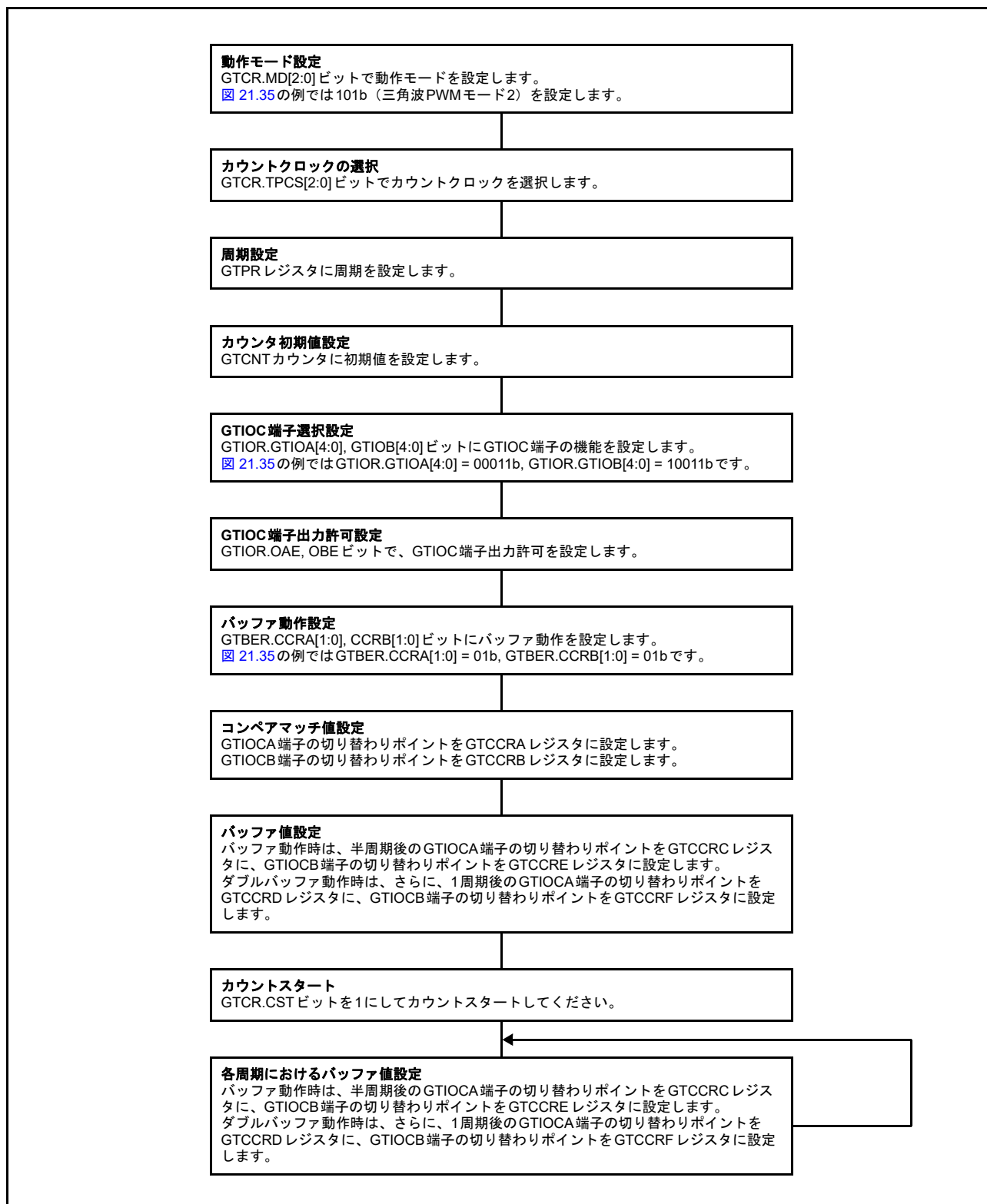
図 21.36 三角波 PWM モード 2 設定例
