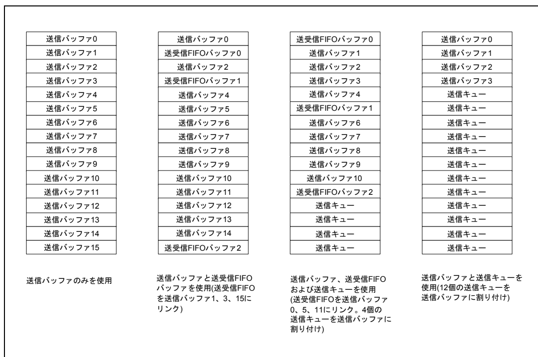
図 20.50 送信キューの割り付けと送受信FIFOバッファのリンク
