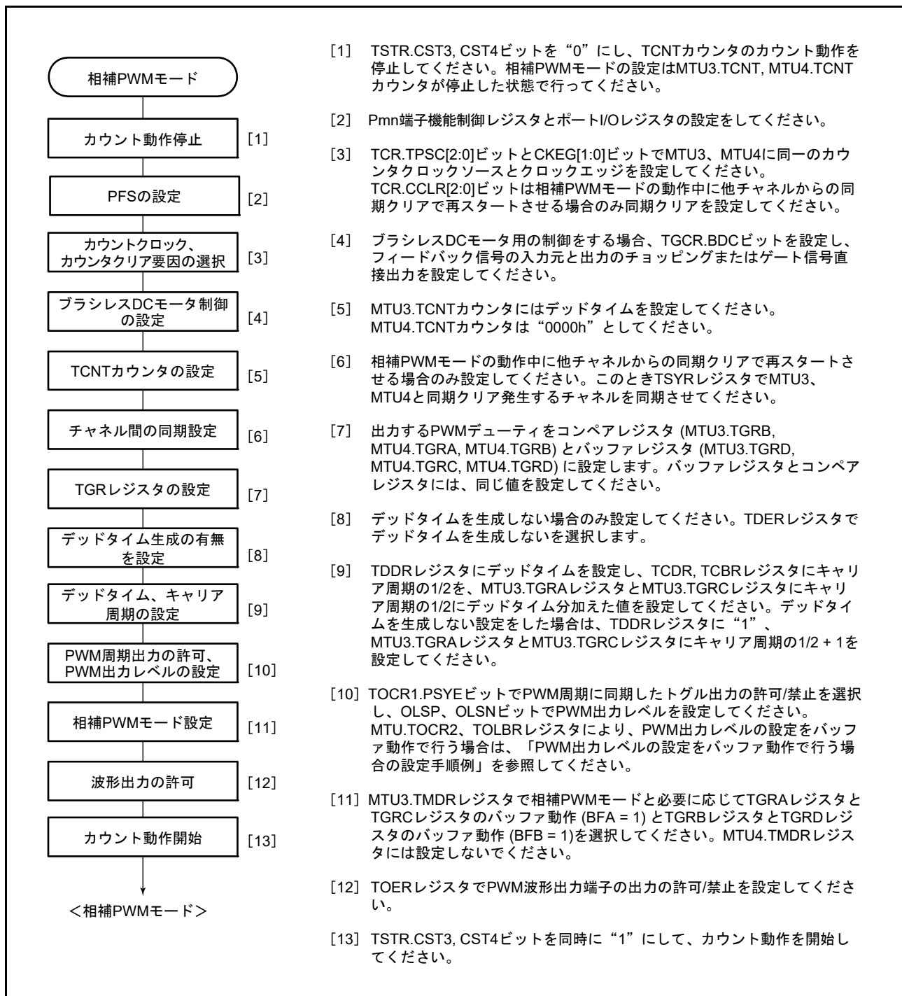
図 22.38 相補 PWM モードの設定手順例
