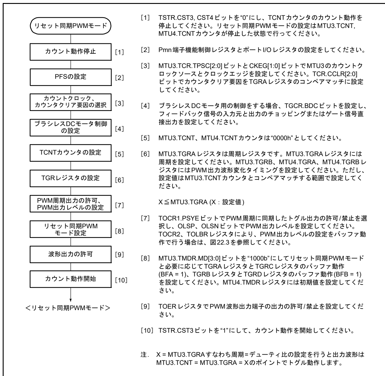
図 22.35 リセット同期 PWM モードの設定手順例
