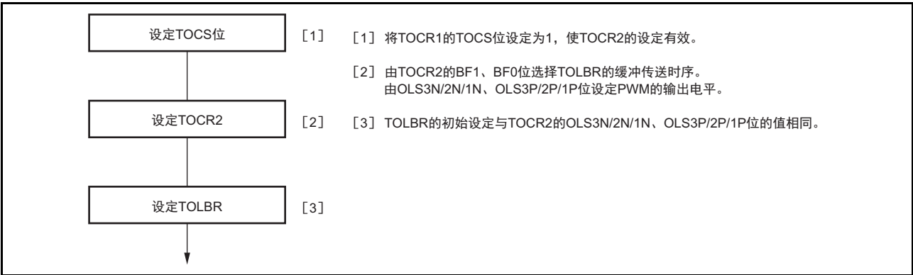
图 10.4 缓冲运行过程中设定 PWM 输出电平的步骤
