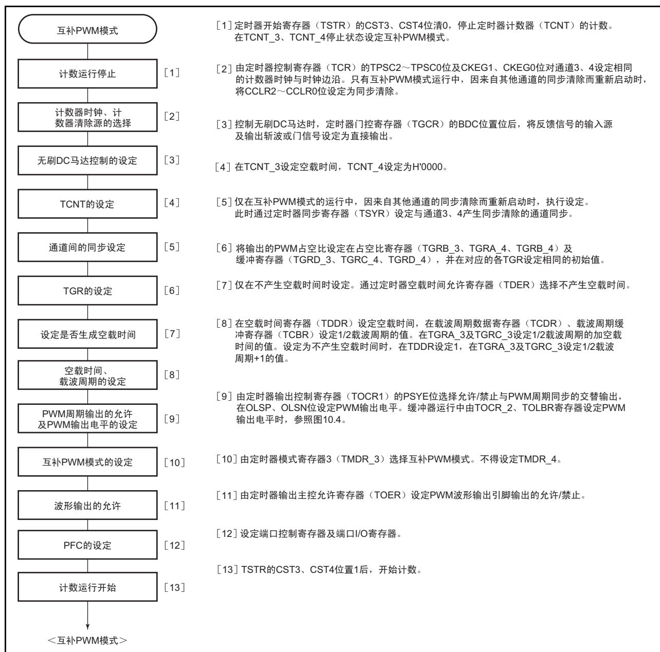
图 10.39 互补 PWM 模式的设定步骤例子
