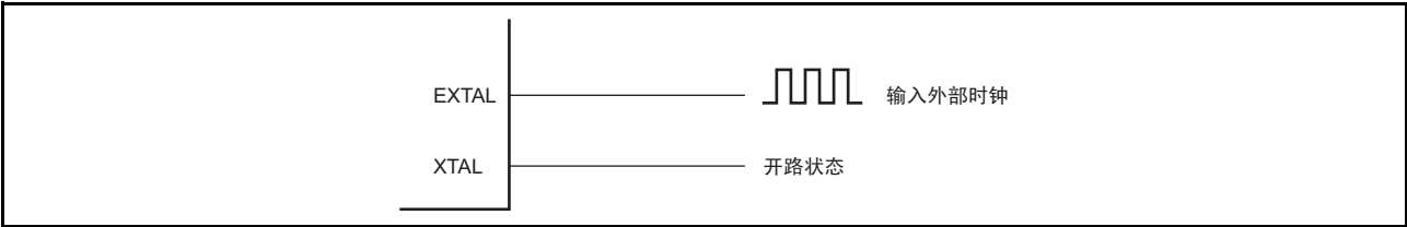
图 4.4 外部时钟的连接例
