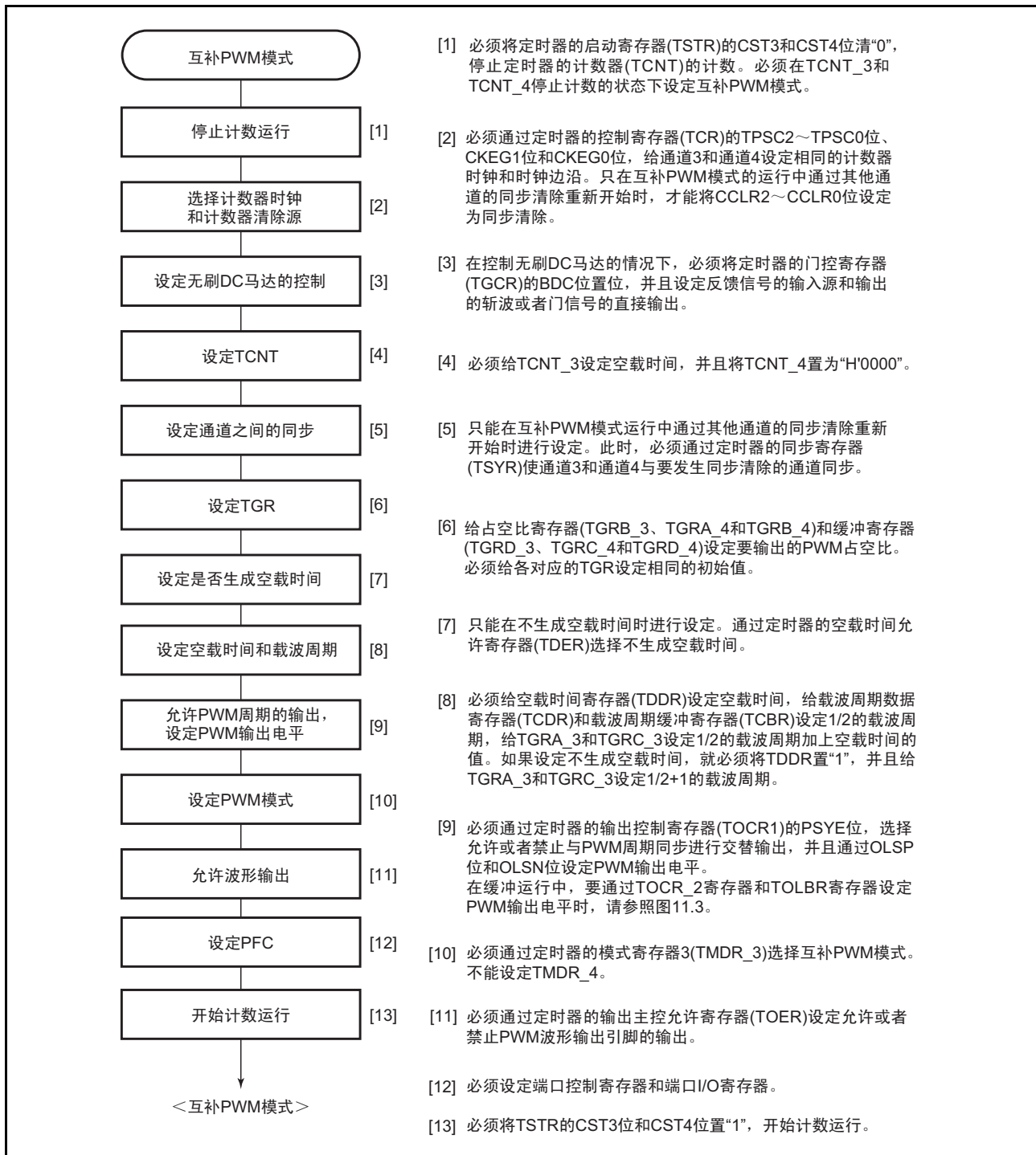
图 12.38 互补 PWM 模式的设定步骤例子
