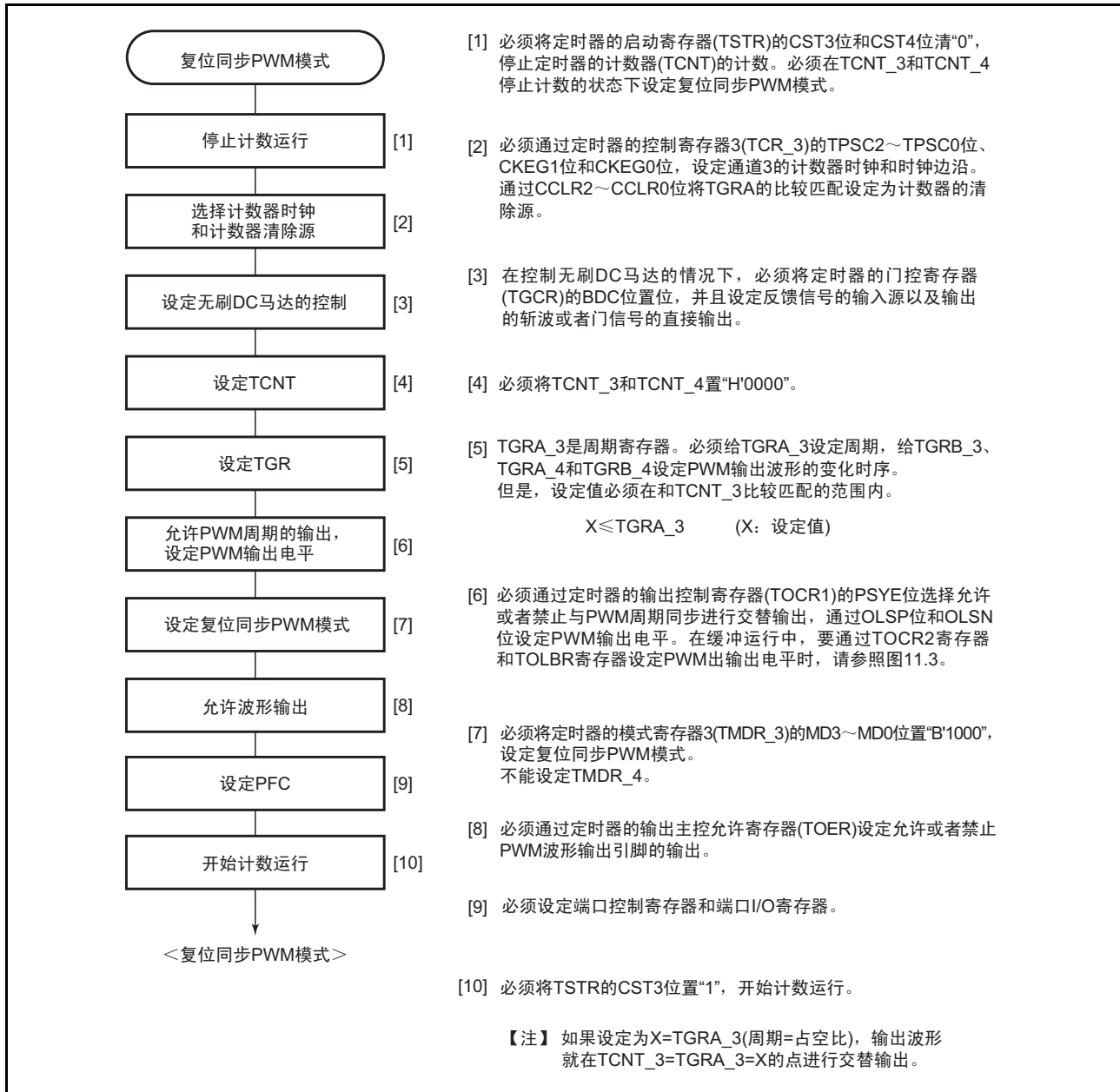
图 12.35 复位同步 PWM 模式的设定步骤例子
