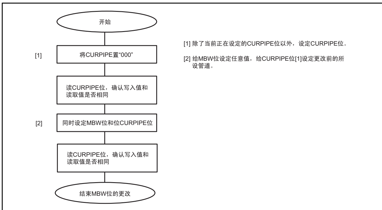
图 29.14 DFIFO0、DFIFO1 或者 CFIFO 的 CURPIPE 位设定为非 DCP (000) 时的 MBW 更改例子
