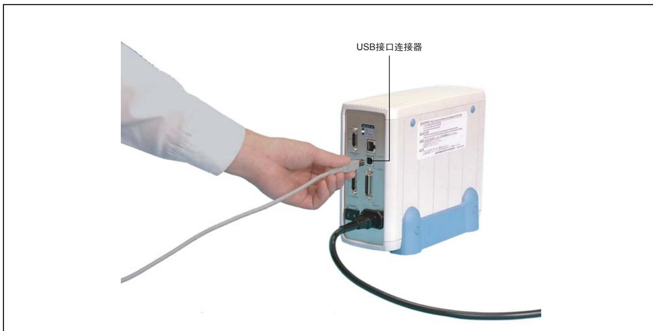
图 4.6 USB 接口电缆的连接（仿真器 PC4701U 侧）
