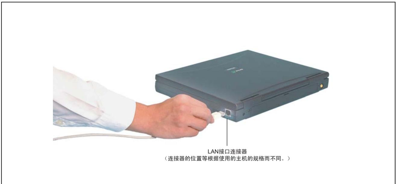
图 4.3 LAN 接口电缆的连接（主机侧）
