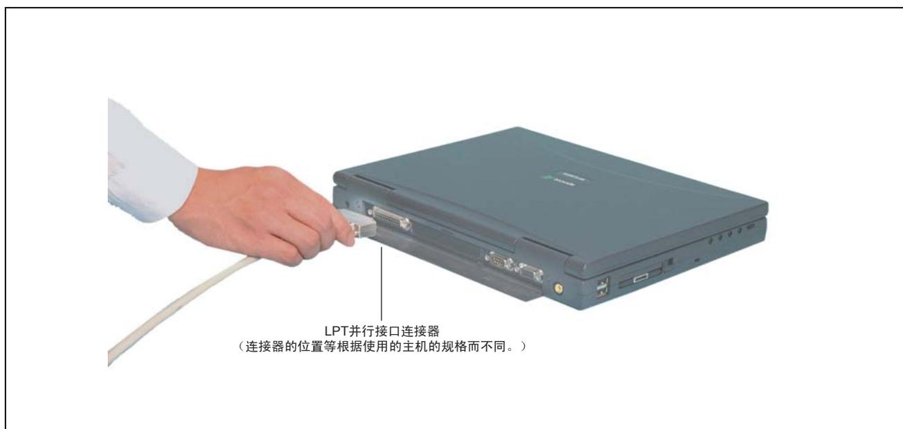
图 4.7 LPT 并行接口电缆的连接（主机侧）
