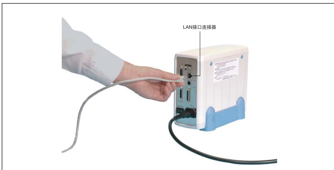
图 4.4 LAN 接口电缆的连接（仿真器 PC4701U 侧）
