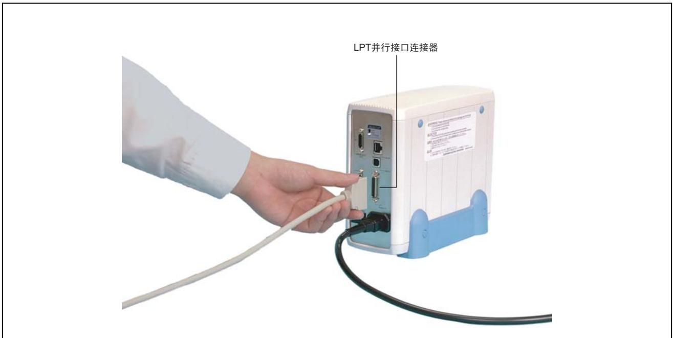
图 4.8 LPT 并行接口电缆的连接（仿真器 PC4701U 侧）
