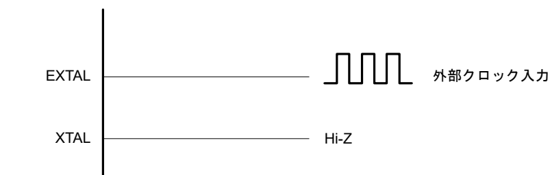
図 8.7 外部クロックの等価回路
