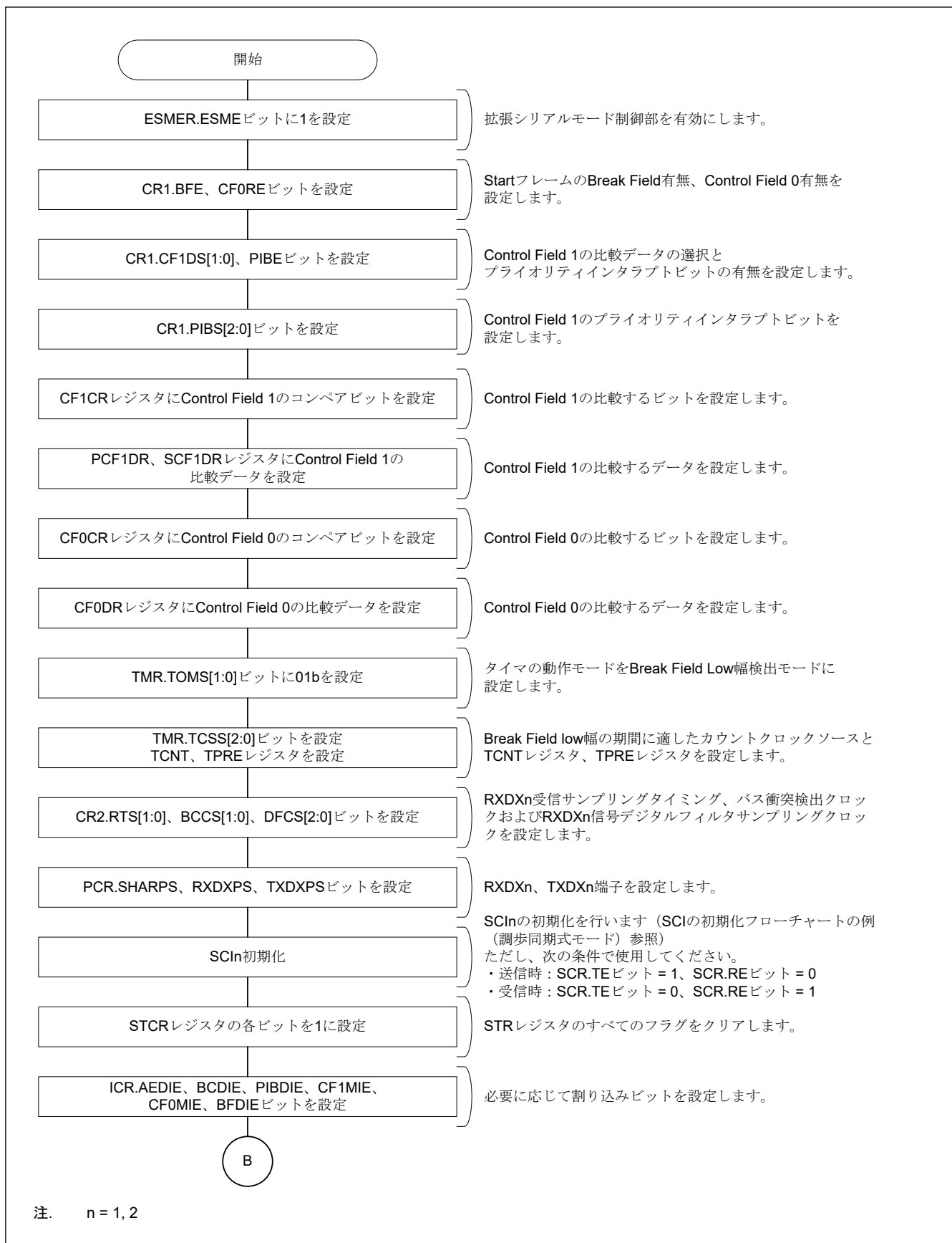
図 27.107 Start Frame 受信フローチャート例 (1)
