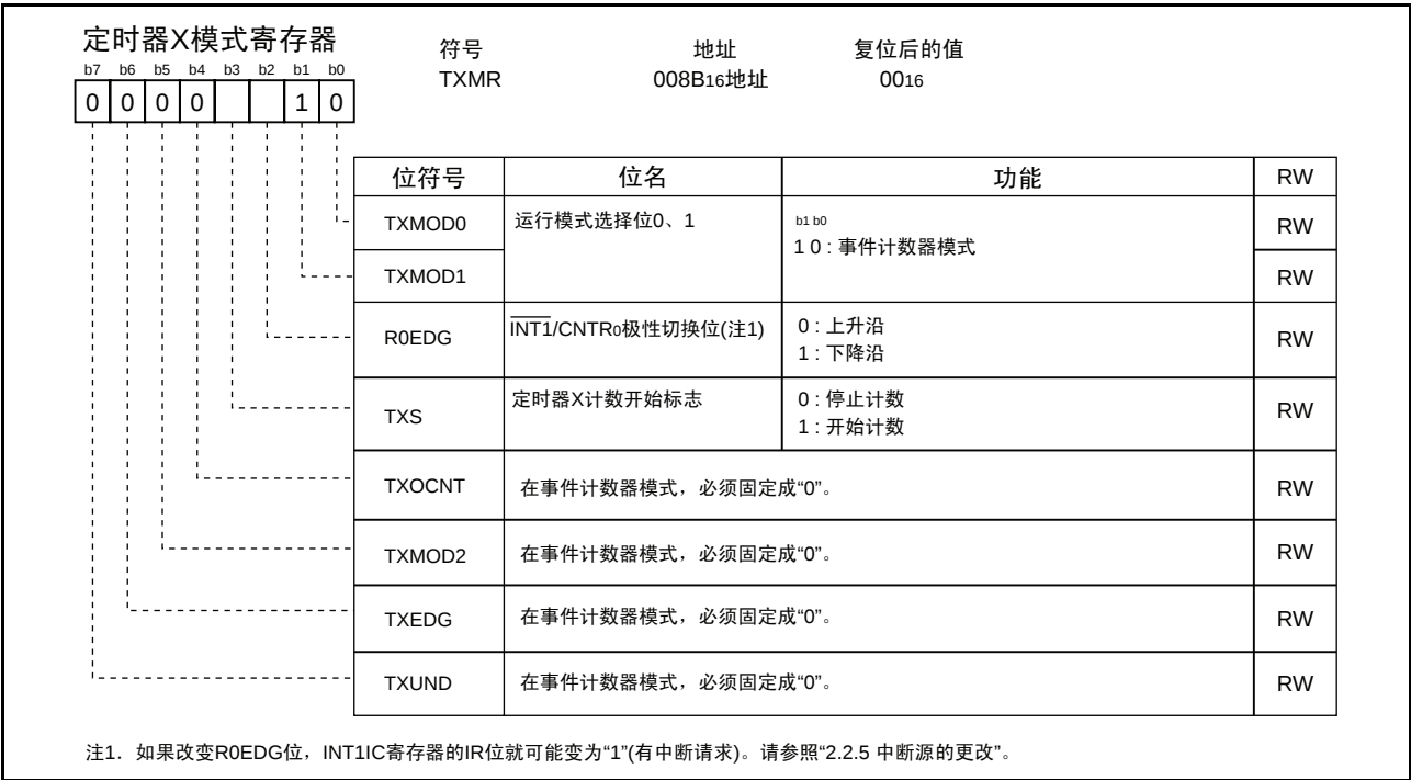
图 13.6 事件计数器模式时的 TXMR 寄存器
