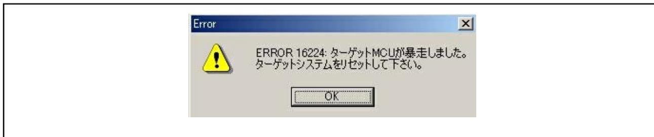
図 6.5 起動時のエラーダイアログ(M3A-2154 評価ボード側異常)
