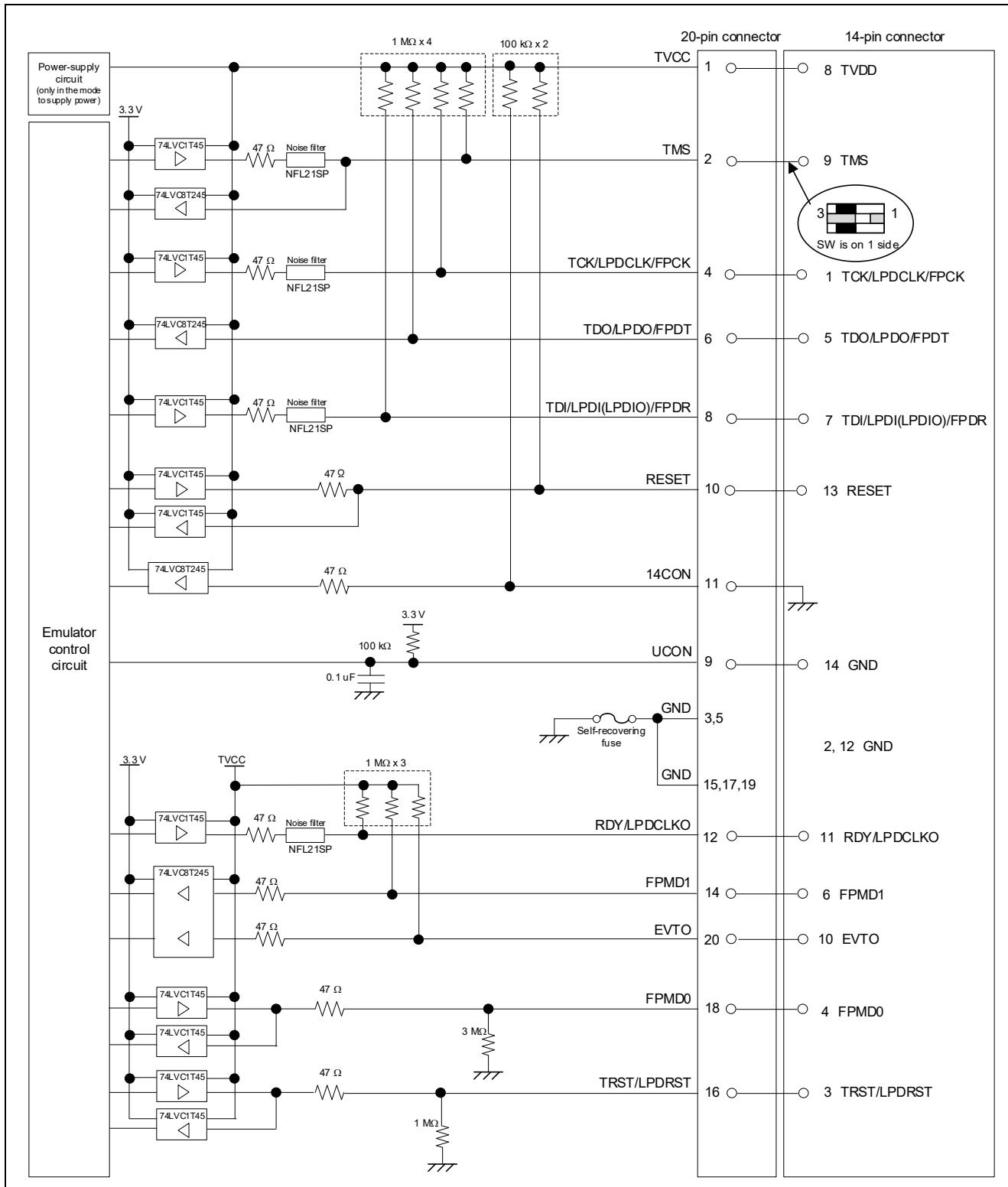
図 5-3 E2 エミュレータ(Rev.C)内インターフェース回路
