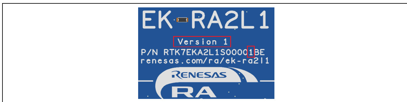
図 5 EK-RA2L1 評価ボード本体のキットバージョンの識別
