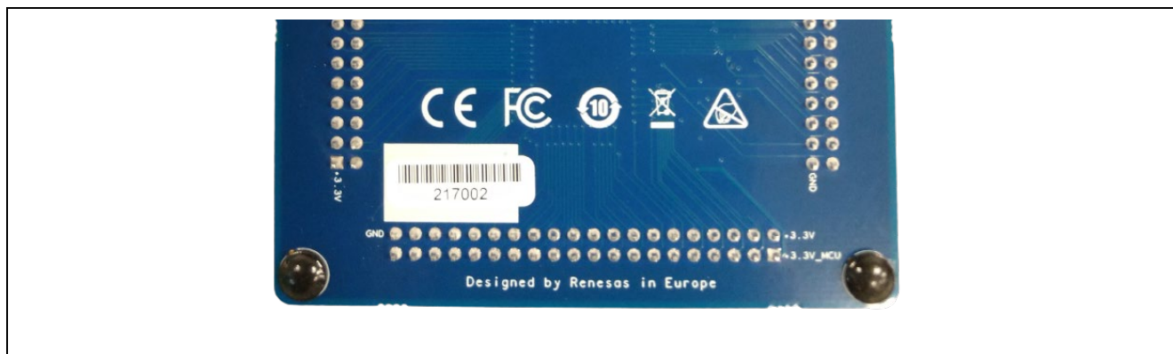
図 7 EK-RA2L1 評価ボードのシリアルナンバーの識別
