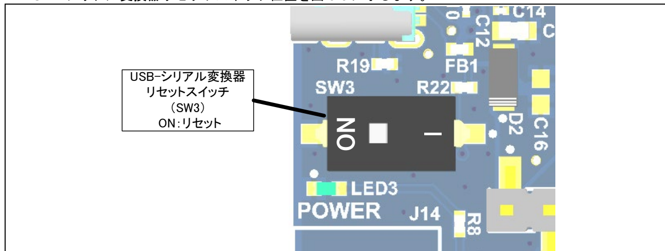
図 5-8 USB-シリアル変換器リセットスイッチ位置
