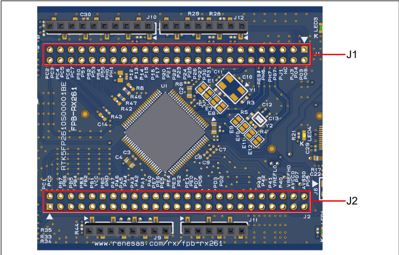
Figure 22. Breakout Pin Headers J1 and J2
