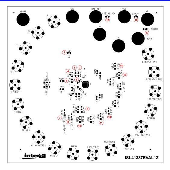
FIGURE 3. JUMPER LOCATOR DIAGRAM
