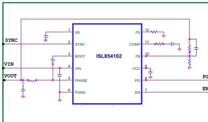
FIGURE 1. BLOCK DIAGRAM
